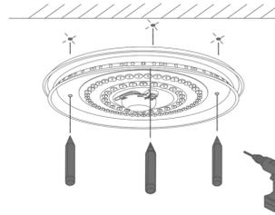
3. 钻孔后再将脚钉打入孔中，将电源线从底盘进行孔引出；
