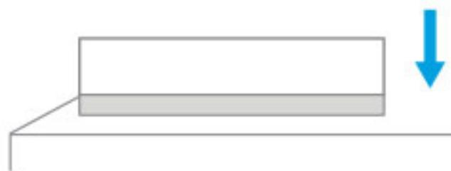
方式二：将双面胶粘贴在无线开关（升级版）底部的硅胶圈内，再粘贴在所需位置即可；
