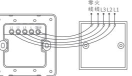
3. 使用附送的螺丝将开关固定到墙壁接线盒上,并扣上开关面板,请务必注意面板与底座的配套与扣接安装方式;
