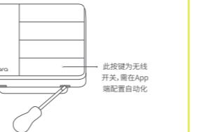
2. 使用螺丝刀拧松开关背面接线柱螺丝,将火线接入L孔,将零线接入N孔(根据家中布线是否留有零线选择是否接入),将负载(灯)线接入L1、L2、L3孔,确认接线正确后,拧紧接线柱螺丝,总负载不能超过2200W;
